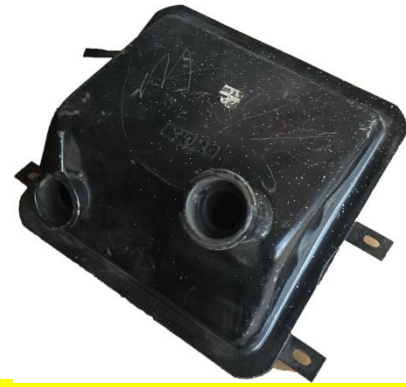
Z-125 İVECO M 23 YEDEK SU DEPOSU
